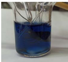
Рисунок 6. Типичный цвет раствора виологеновых соединений в катион-радикальном состоянии
